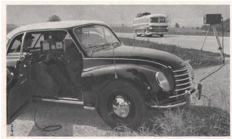
Verkehrsradar VRG 2 im Einsatz
