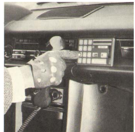
Bild 1 Montiertes Automatic-Autotelefon S mit Selbstwahltechnik (Werkbild: AEG-Telefunken)
